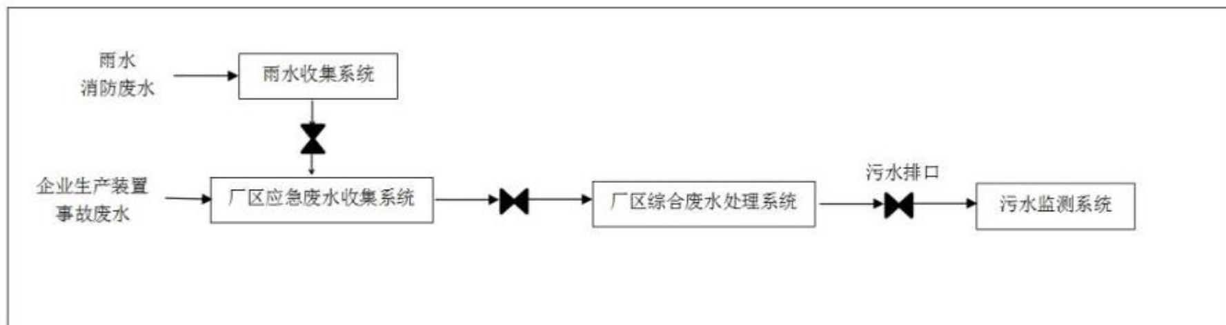
附图 8 防治事故水进入外环境的控制、封堵系统图
