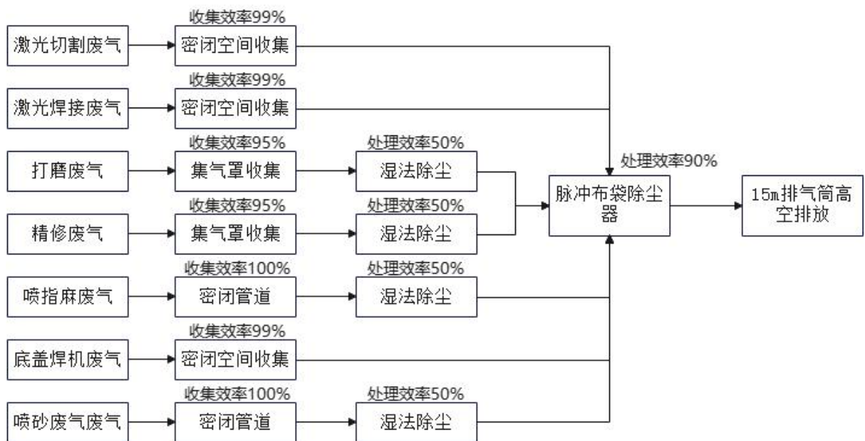
图 4-2 项目各股废气处理走向图
