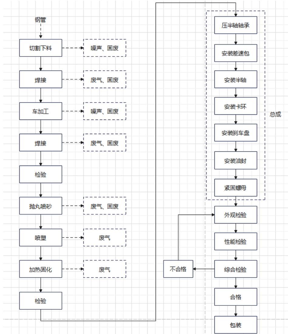
图2-4 新能源汽车驱动后桥生产工艺流程及产排污环节图
